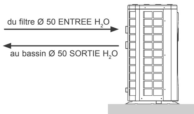
Installer une vanne dite "by-pass" entre l'entrée et la sortie de la pompe à chaleur.
