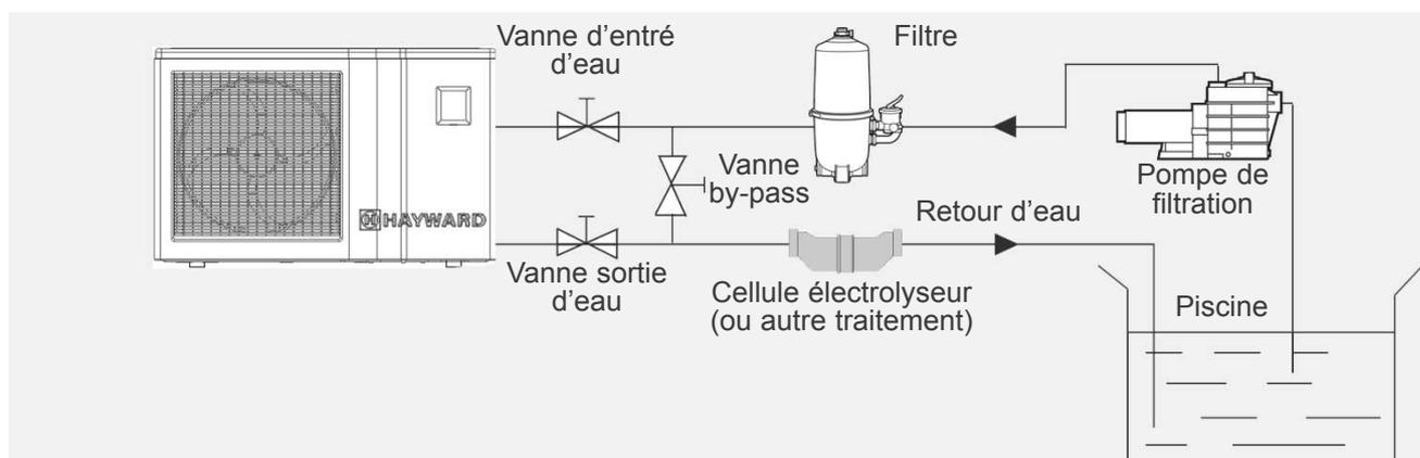
Note : La pompe à chaleur est fournie sans aucun équipement de traitement ou de filtration. Les éléments présentés sur le schéma sont des pièces à fournir par l'installateur.
