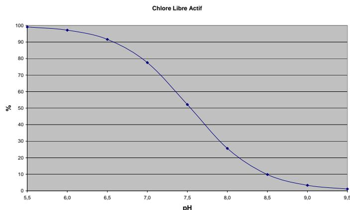
Une eau trop acide (pH <6,8) est agressive pour les muqueuses, favorise la corrosion des pièces métalliques et peut endommager les plastiques (liners).
