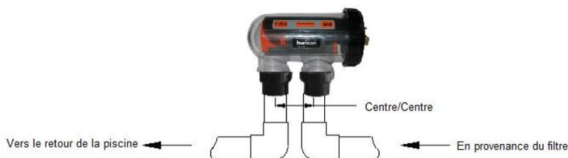
**AVERTISSEMENT :** Il est très important que le gaz généré par la cellule ne s'accumule pas dans les tuyaux et ne retourne pas dans le filtre et la pompe.
