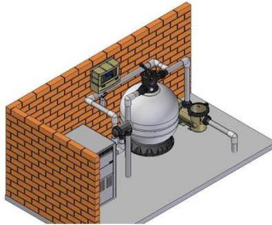
Une fois que la cellule est installée, connectez le câble noir à la cellule. Le câble bleu doit être connecté à la borne bleue. Le câble de la cellule est conçu pour connecter par le dessous de la cellule. Veillez à ce que les écrous papillon soient serrés correctement afin de garantir un bon contact.
